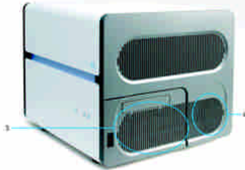
圖 3：儀器右下角的通風入口
