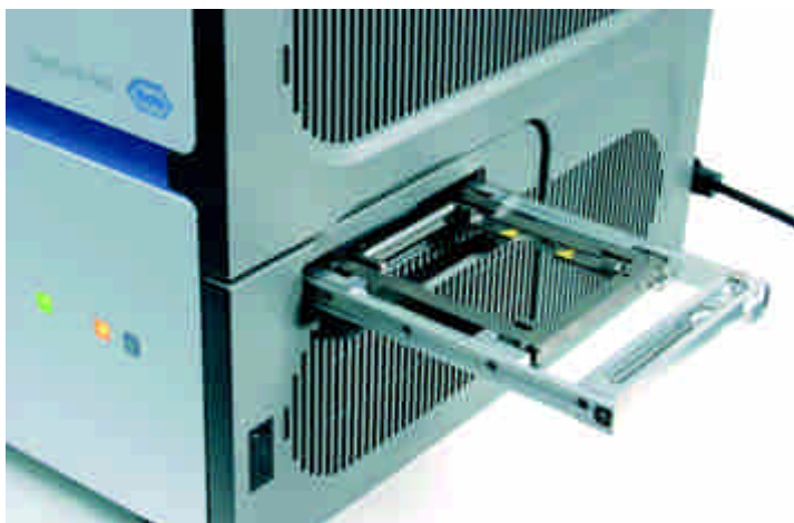
圖 11：儀器多孔板載入器伸出視圖。
