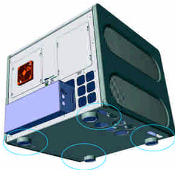
圖 4：儀器底板搬運把手位置示意圖。
